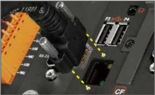
▲可螺丝锁固之 RJ45 接头
