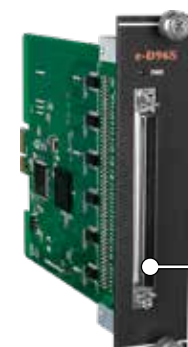
e-D96S e-Bus接口, 96通道数字输出卡
