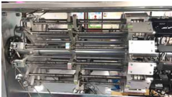
▲ 图三、控制机箱内的多轴线性致动器
