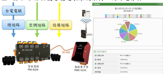
▲ 图3 泓格科技智能电表系统架构以及用电分析
