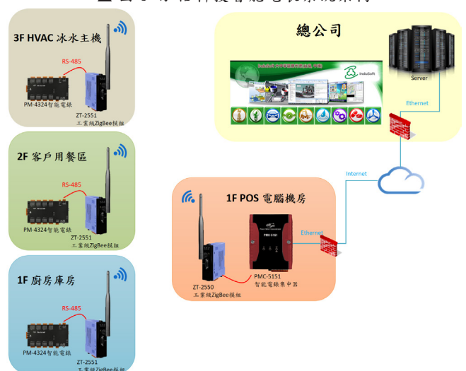
▲ 图5 泓格科技智能电表系统架构
